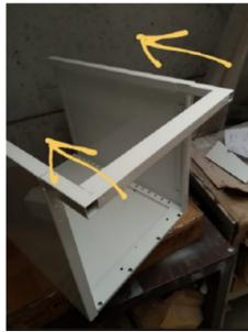
**4** Coloca la Cubierta (E) de adelante hacia atrás. Asegúrate que el borde superior de los laterales y la trasera queden entremedio del "clip" que va en la parte interna de la cubierta antes de hacer la presión hacia abajo.
