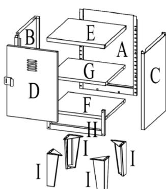
**1** Une la pieza trasera (A) con el lateral izquierdo (B) fijándolo con 2 tornillos de medida 4\*8
